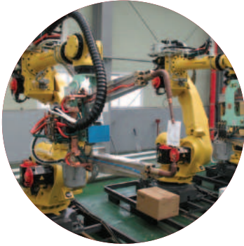
Gambar 1.9 FANUC R-2000iB, robot industri yang digunakan dalam proses pengepakan dan pelabelan otomatis
